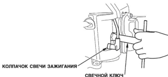
3. Осмотреть свечу зажигания. Заменить свечу, если она повреждена, если уплотнительная шайба в плохом состоянии, или изношен электрод.
